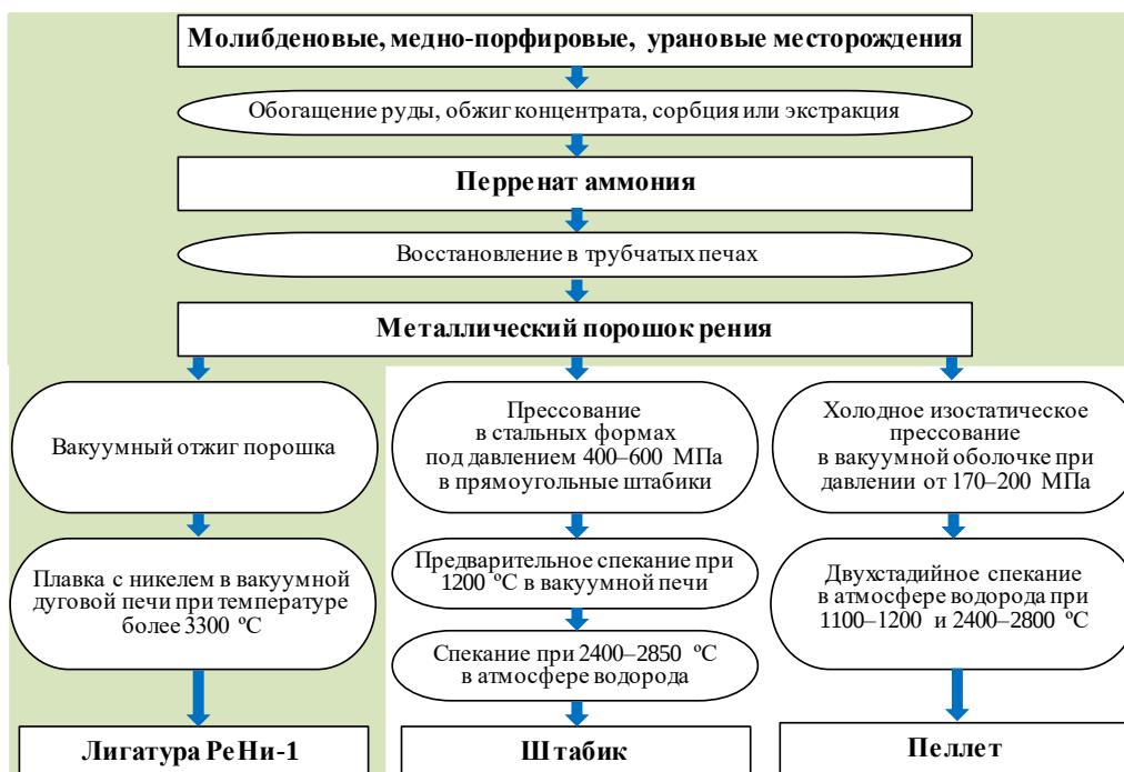
Рис. 5. Технологическая схема получения компактных материалов из рения
