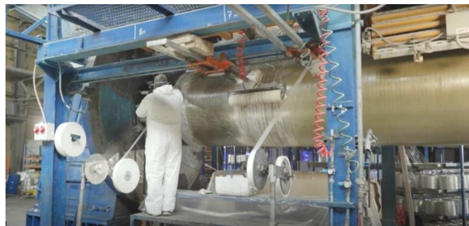
Рис. 11. Установка для непрерывной намотки стеклопластиковых труб
