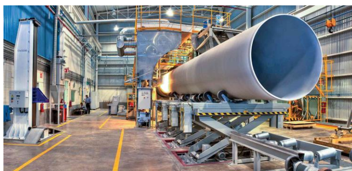
Рис. 9. Стеклопластиковая труба, изготовленная по технологии непрерывной намотки
