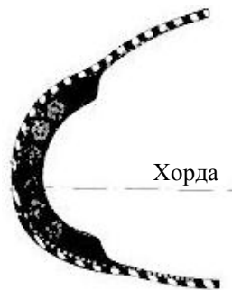
Рис. 3. Нагревательная накладка лопасти несущего винта, состоящая из слоев стекло- или углеткани, жил силовых проводов нагревательного элемента и заполнителя
