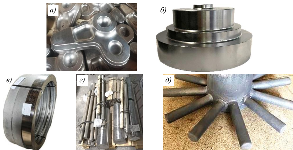
Рис. 1. Полуфабрикаты из сплава ВТ46 (ВТ46Л): а – штамповка, изготовленная с помощью молота, с габаритными размерами 343×263×92 мм и массой 14 кг; б – штамповка, изготовленная на изотермическом прессе, с габаритными размерами Ø260×150 мм, максимальным сечением под термическую обработку 96 мм и массой 25 кг в обточенном состоянии; в – цельнокатаные кольца (размеры одного кольца – диаметры D_{нар} = 945 мм, D_{вн} = 802 мм, высота стенки H = 100 мм, масса 86,5 кг); г – промышленные кованные и катаные прутки диаметром 35; 43 и 150 мм; д – опытная отливка для определения механических свойств диаметром 23 мм с фрагментом прибыли, после литья
