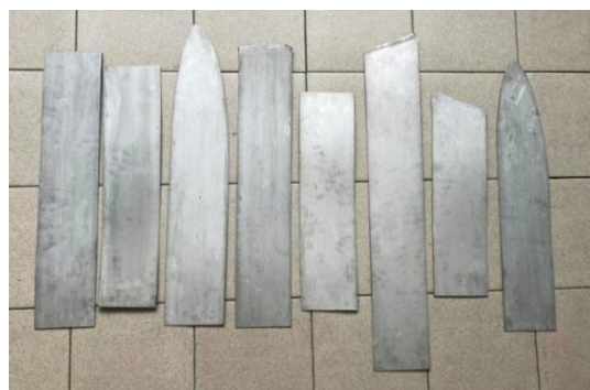
Рис. 2. Присадочные материалы экспериментальных составов в виде листов
