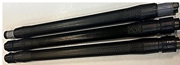
Рис. 10. Заготовки элемента тяги системы управления вертолетной техники
