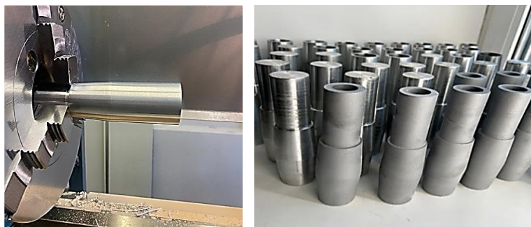
Рис. 6. Изготовление металлических закладных элементов
