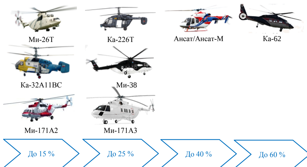
Рис. 1. Доля полимерных композиционных материалов в конструкциях отечественной вертолетной техники гражданского назначения
