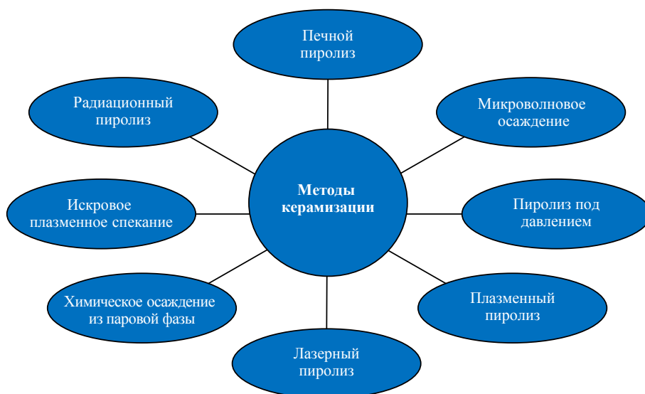
Рис. 5. Наиболее распространенные методы керамизации предкерамических полимеров
