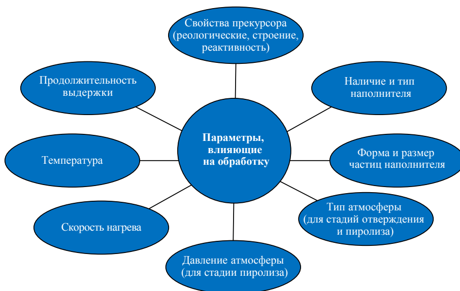
Рис. 8. Основные параметры, влияющие на обработку предкерамических полимеров
