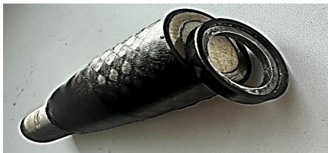
Рис. 11. Внутренняя структура заготовки элемента тяги управления
