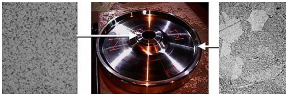
Рис. 15. Заготовка турбинного диска из сплава Alloy 10, полученного методом DMHT (Dual Micro Heat Treatment) [39]
