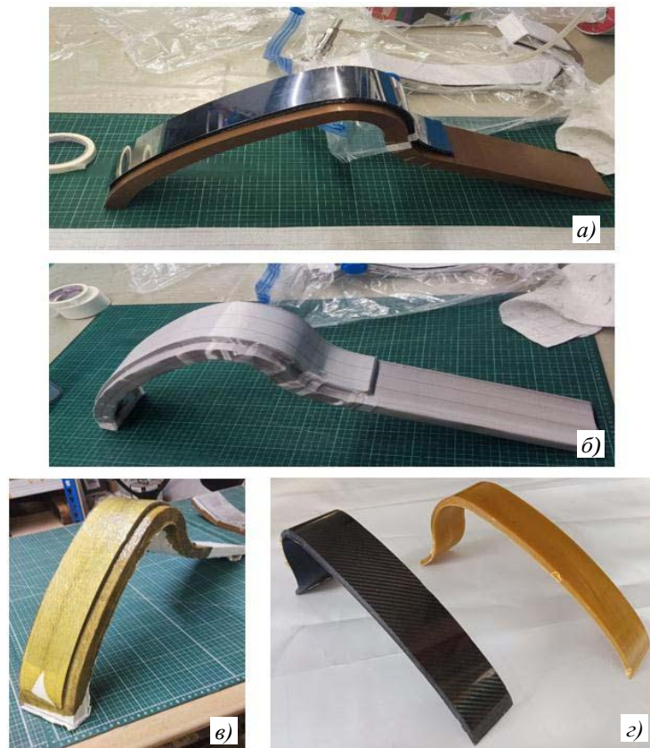
Рис. 6. Стадии подготовки сборки вакуумного технологического пакета: а – выложенный препрег на формообразующей оснастке с «лицевой» цулагой; б – сборка с жертвенной тканью; в – сборка после отверждения связующего; з – экспериментальные конструктивно-подобные образцы панелей корпусной конструкции сложной формы – фрагмента модуля стопы из угле- и стеклопластиков
