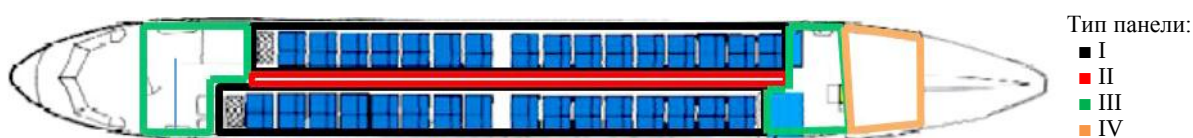
Рис. 2. Панели пола салона и багажно-грузового отсека самолета Ил-114-300
