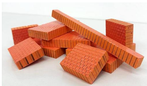
Рис. 4. Образцы сотовых панелей, заполненные сферопластиком марки ВПЗ-25
