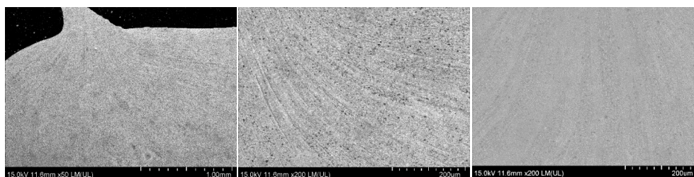
Рис. 16. Микроструктуры образцов из поршня из металлического композиционного материала на основе алюминиевого сплава системы Al–Cu–Mg–Si, армированного тугоплавкими частицами SiC
