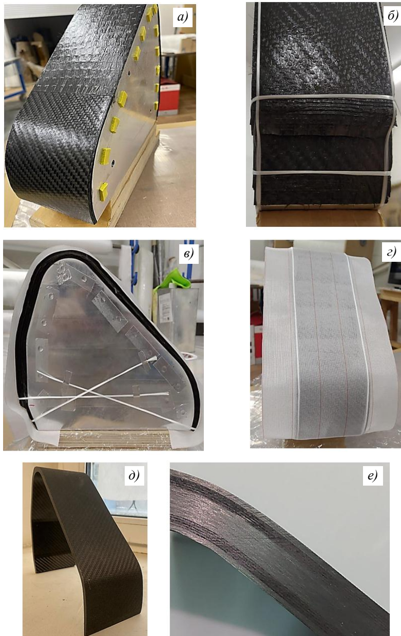
Рис. 6. Изготовление конструктивно-подобного элемента фрагмента модуля стопы с использованием семипрегов: а – сборка слоев наполнителя на оснастке; б – организация вакуумирования и отвода летучих компонентов в вакуумном пакете; в , г – размещение жертвенной ткани для обеспечения вакуумирования; д – изделие после торцовки; е – послойное чередование равнопрочных и однонаправленных слоев семипрегов
