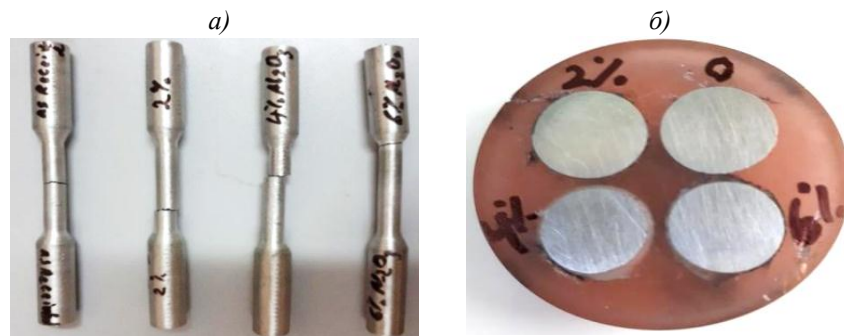
Рис. 12. Образцы из сплава состава AlSi12Cu1(Fe) и металлического композиционного материала на его основе для испытания на растяжение (а) и для определения твердости (б)
