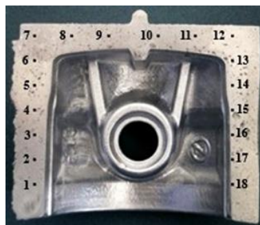
Рис. 4. Точки измерения твердости в поперечном сечении поршня [15]
