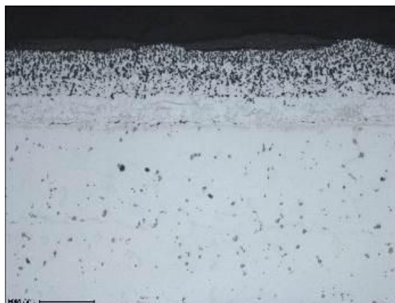
Рис. 3. Микроструктура образца из сплава ВЖЛ21-ВИ с нанесенным градиентным защитным покрытием композиции СДП-1 + ВСДП-13 при действии модернизированного инвертора отрицательного потенциала в постоянном режиме после проведения испытаний на СОК при температуре 950 °С на базе 30 циклов
