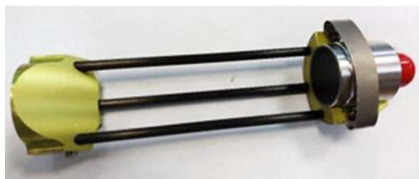
Рис. 4. Оснастка с коническим зеркалом, закрепленная на преобразователе
