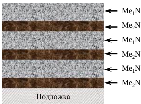
Рис. 1. Стандартная структура биметаллического покрытия типа (TiAl)N/TiN
