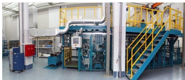
Рис. 1. Пропиточная машина для изготовления препрега по расплавной технологии
