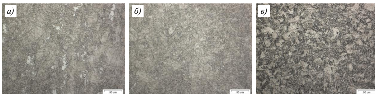
Рис. 2. Микроструктуры ( \times 500 ) образцов из мартенситостареющей стали 21HKMT после однократного старения (а), двукратного старения (б) и перестаривания (в)
