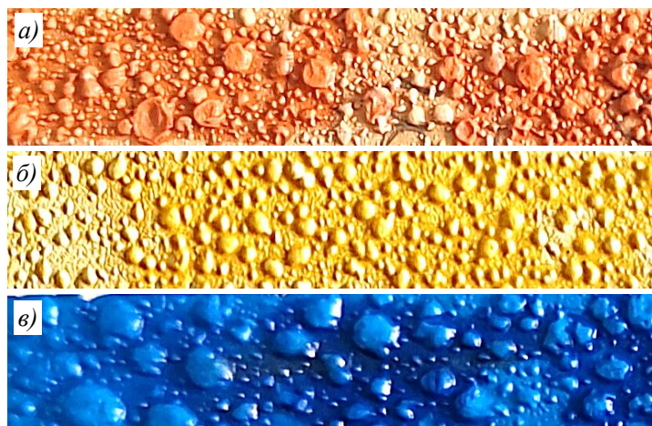
Рис. 4. Внешний вид покрытия АС-1115 на поверхности образцов пластин Г7 (а), Г8 (б) и Г9 (в) после 65 сут увлажнения
