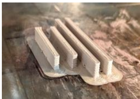
Рис. 6. Образцы брусков, изготовленные из филамента состава 20%ЖКП + 80%ПЭЭК (печать «ребром»)
