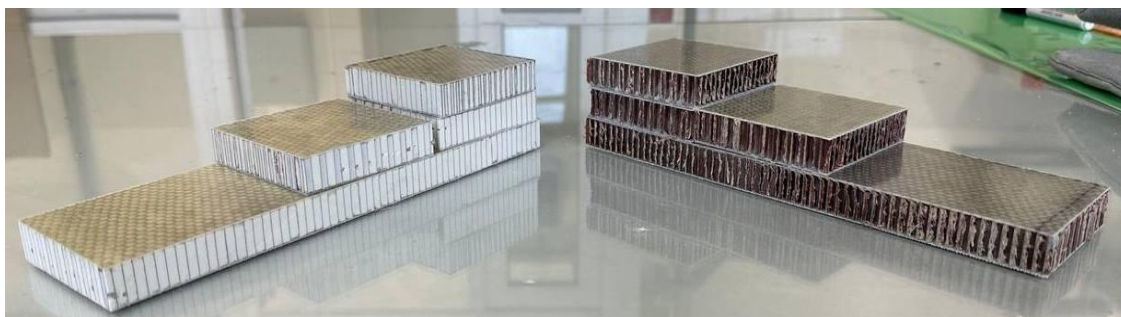
Рис. 2. Трехслойные сотовые панели на основе экспериментальной композиции связующего
