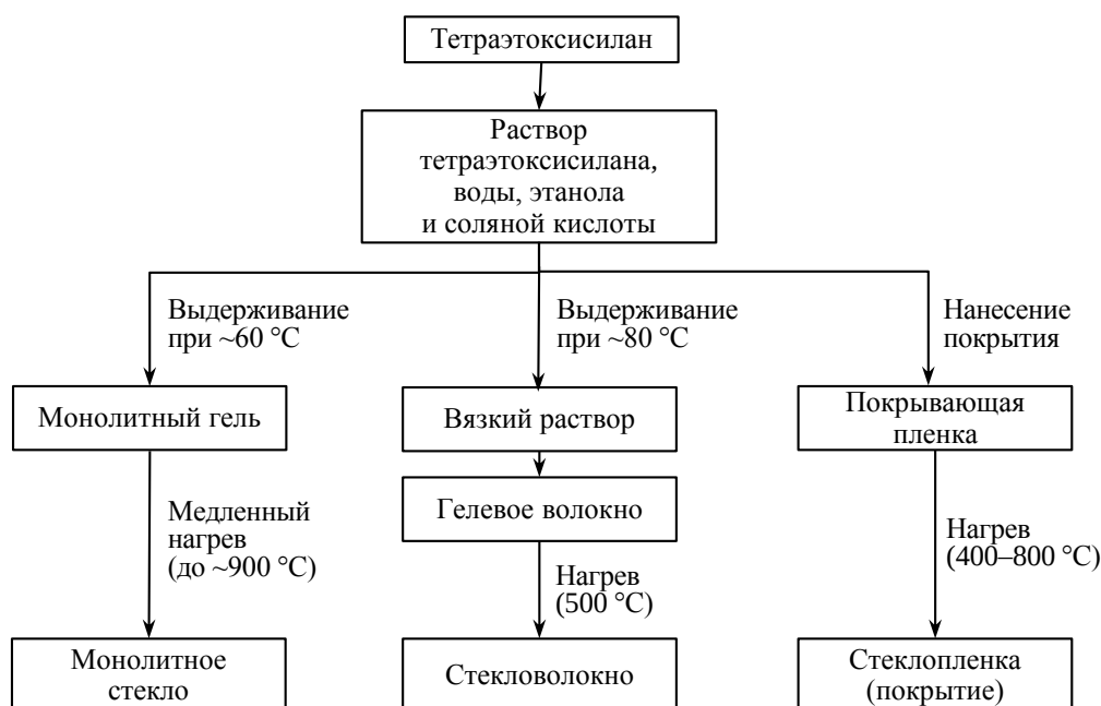
Рис. 1. Технологическая схема получения стекла, стекловолокна и стеклопокрытия
