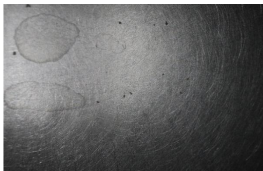
Рис. 3. Подвергнутая зачистке поверхность обшивки воздушного судна, на которой наблюдаются питтинги
