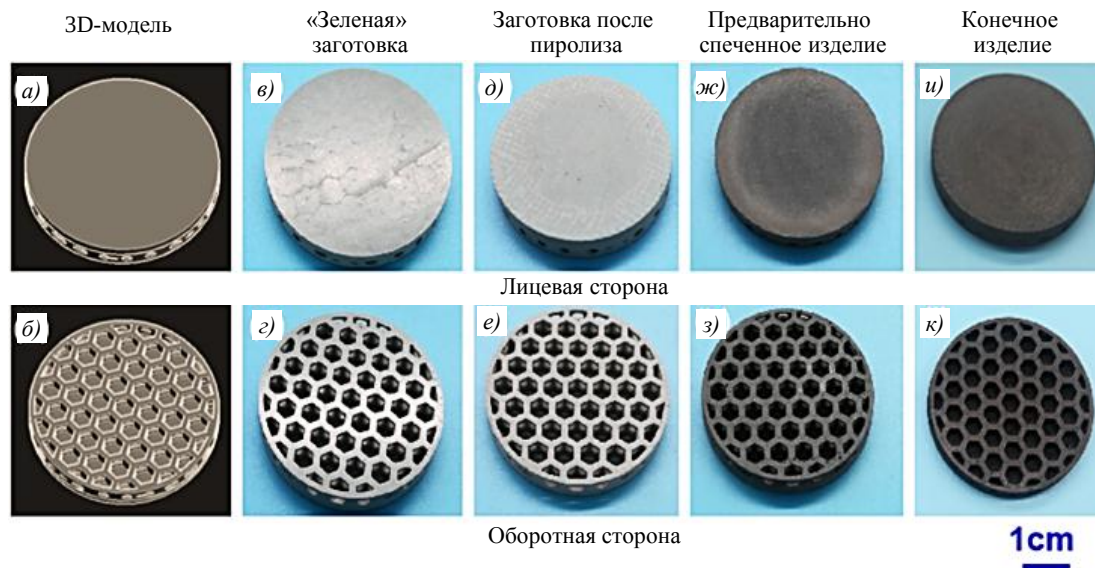
Рис. 3. Легкое керамическое оптическое зеркало из карбида кремния: а, б – 3D-модель для стереолитографии; в, г – «зеленая» заготовка; д, е – заготовка после пиролиза; ж, з – предварительно спеченное изделие; и, к – конечное изделие
