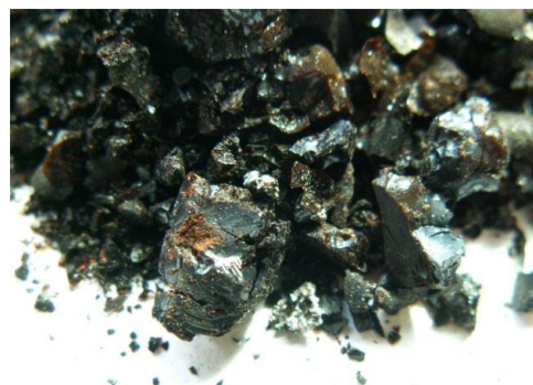
Рис. 8. Внешний вид термообработанного геля с углем и крахмалом (температура термообработки 350 °С)
