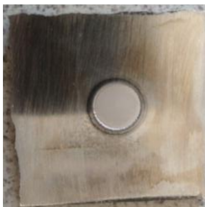
Рис. 2. Образец никеля высокой чистоты после анализа методом МСТР
