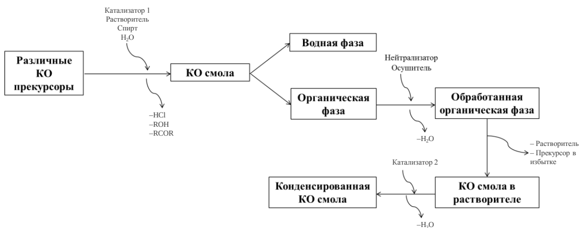
Рис. 1. Схематическое изображение различных методов синтеза кремнийорганических (КО) смол
