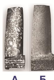
Лопатка, полученная без модификатора (А) и с модификатором (Б)
