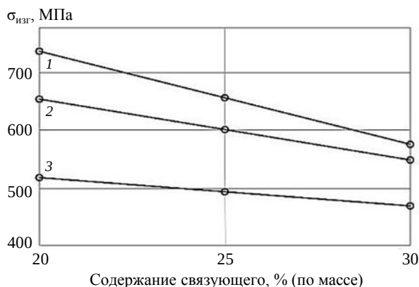
Рис. 8. Диаграмма изменения значений предела прочности при изгибе в зависимости от содержания полимерного связующего в нетермоциклированных стеклопластиках: 1 – однонаправленных; 2 – перекрестно армированных; 3 – квазиизотропных
