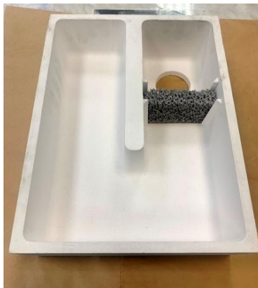
Рис. 1. Пенокерамический фильтр, установленный в металлоприемник
