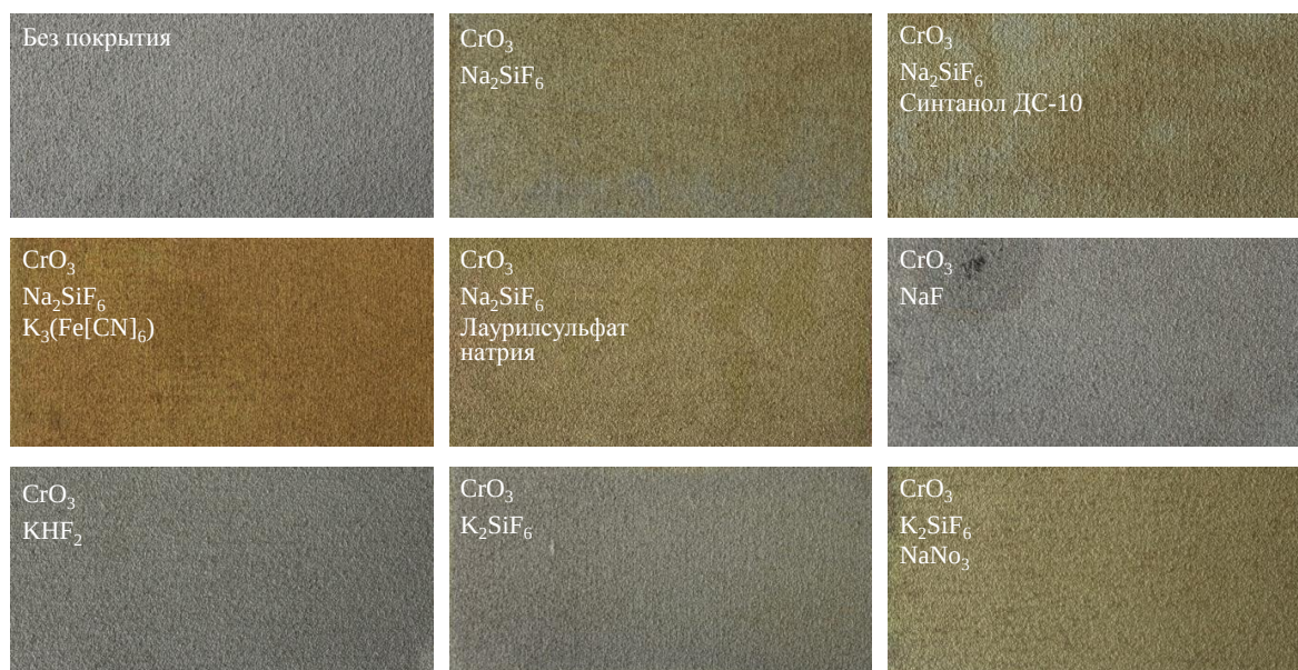
Рис. 2. Внешний вид покрытий, формируемых в различных составах электролитов химического оксидирования на сплаве ВАС1
