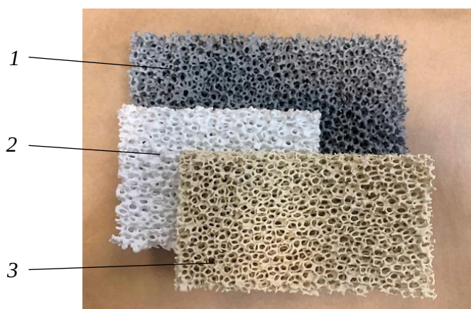
Рис. 2. Изготовленные образцы пенокерамических фильтров ПФ-1 (1), ПФ-2 (2) и ПФ-3 (3)
