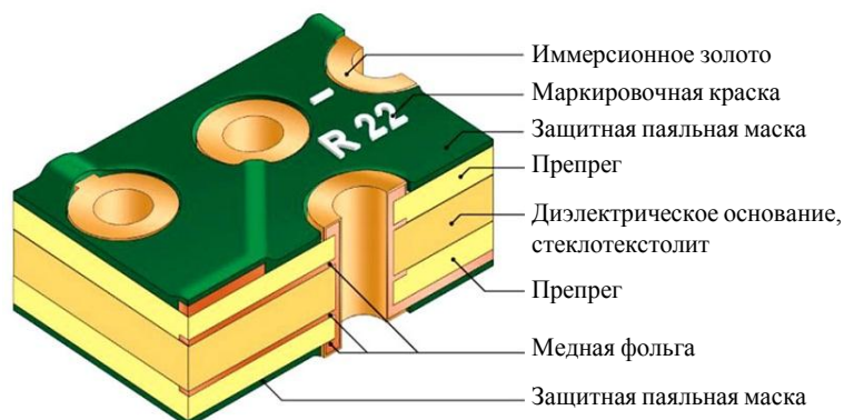
Рис. 2. Схема многослойной печатной платы [12]
