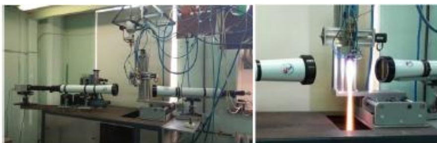
Рис. 5. Внешний вид установки для сфероидизации порошков ниобия
