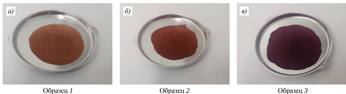
Рис. 2. Внешний вид образцов металлопорошковой композиции сплава на основе меди до процесса синтеза (а) и после него (б, в) на установке DMP Flex 350
