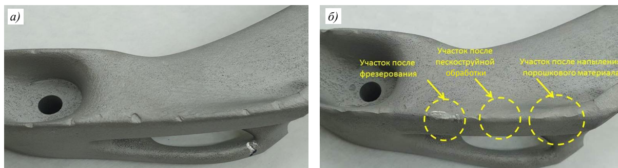
Рис. 8. Внешний вид детали «Кронштейн» из сплава ВАС-1: а – исходное состояние; б – этапы устранения дефектов
