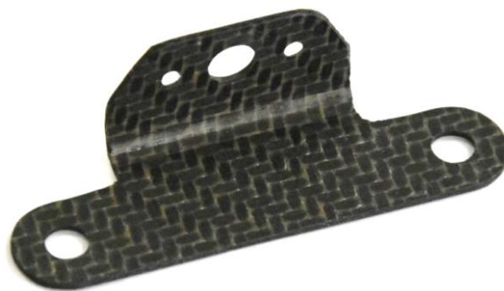
Рис. 5. Конструктивно-подобный образец элемента мотогондолы – кронштейн из листового углепластика ВКУ-65
