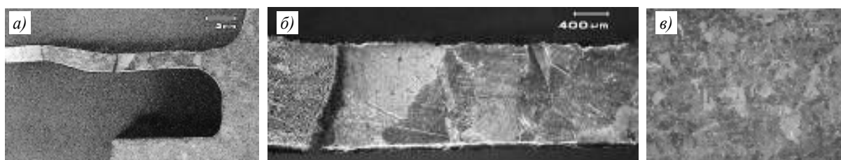
Рис. 3. Макроструктура детали в зоне образования трещин (торец заготовки) (а); микроструктура: б – крупные зерна в зоне образования трещин; в – мелкие зерна в середине детали
