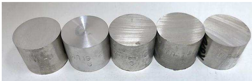
Рис. 3. Комплект стандартных образцов состава магниевое сплава МЛ19
