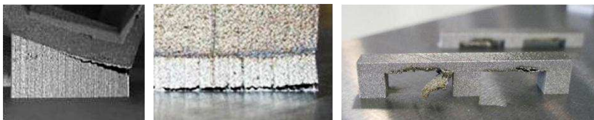
Рис. 1. Искажение геометрической формы деталей вследствие больших внутренних напряжений, а также при печати поверхностей под углом больше критического
