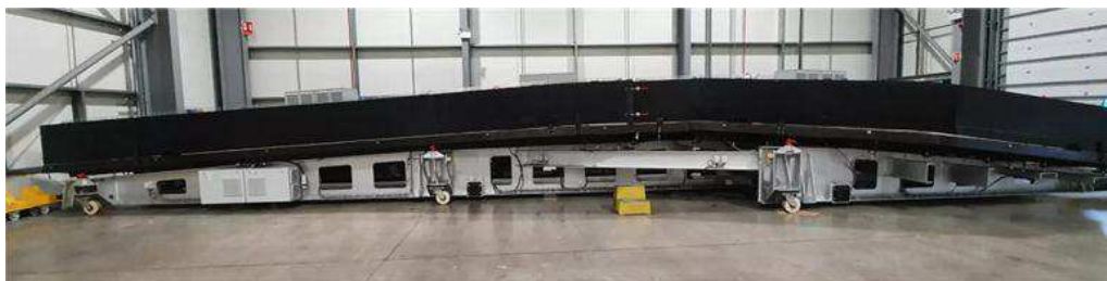
Рис. 2. Полномасштабная 17-метровая оснастка для обшивки нижней части крыла [14]
