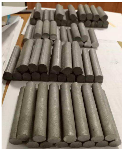
Рис. 3. Синтезированные заготовки из сплава ВТ6-ПС, полученные на установке 3DSystems DMP 350 Flex
