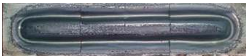
Рис. 2. Составная мишень из сплава системы Zr–Y после эксплуатации
