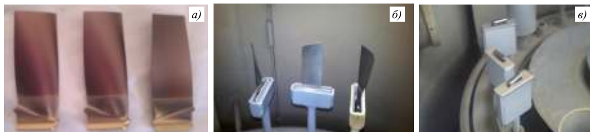
Рис. 1. Внешний вид лопаток компрессора с многослойным эрозионностойким и фреттингостойким покрытиями (а), а также в оснастке для нанесения эрозионностойкого (б) и фреттингостойкого покрытий (в)
