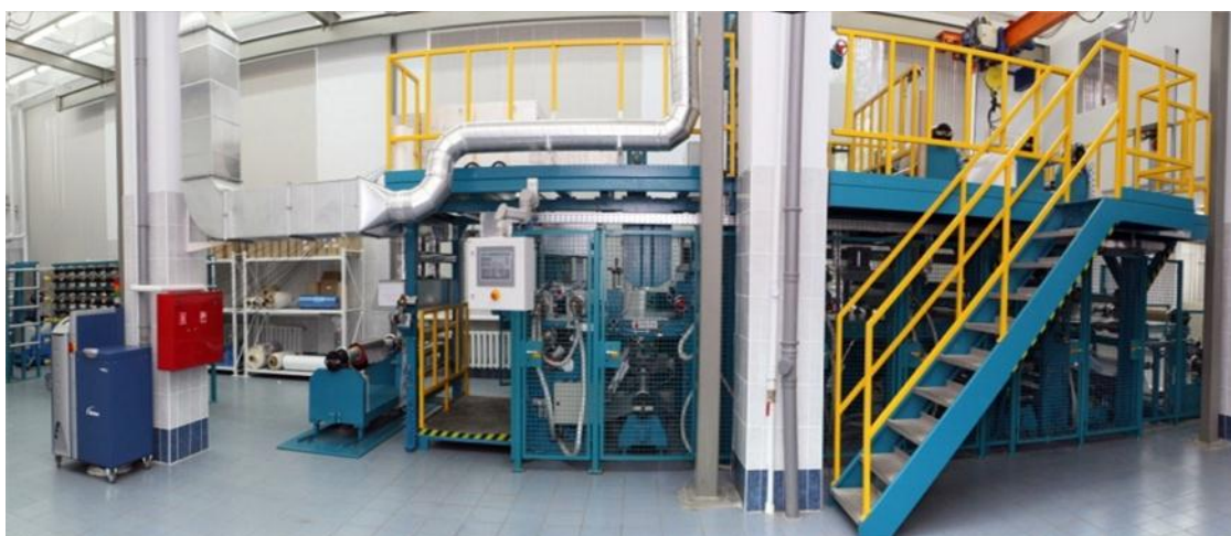
Рис. 2. Установка по изготовлению калиброванных прецизионных препрегов Coatema BL-2800 (Германия)
