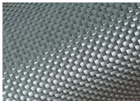
Рис. 3. Углеродная равнопрочная ткань полотняного плетения марки ВТкУ-7 с поверхностной плотностью 585 г/м 2
