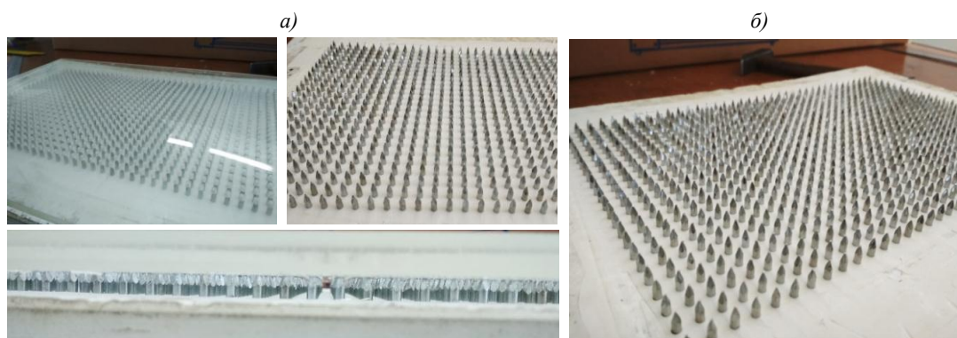
Рис. 5. Специальная оснастка для перфорирования углепластика:
