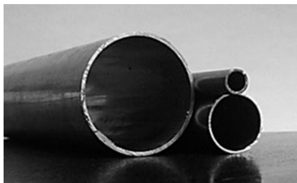
Рис. 1. Внешний вид холоднодеформированных тонкостенных труб из сплава В-1341
