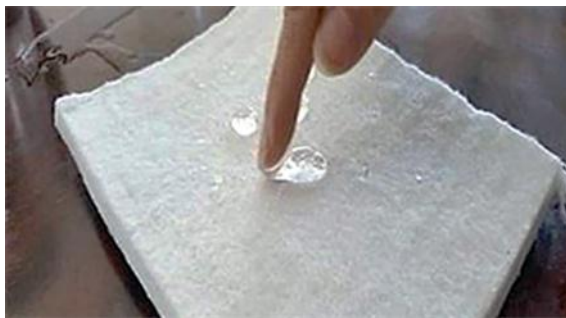
Рис. 5. Гидрофобный аэрогелевый композит, не смачиваемый водой [21]
