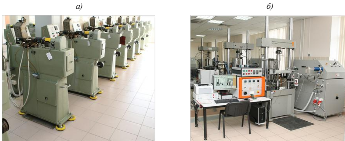
Рис. 1. Односекционные испытательные машины МВИ611-М (а) и испытательная машина LFV 100-НН фирмы Walter+Bai AG (б)
