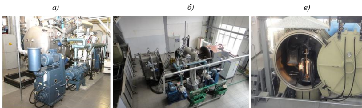
Рис. 1. Вакуумные плавильные установки УВНК-9А (а), УВНК-15 (б) и УВНК-10 (в)
