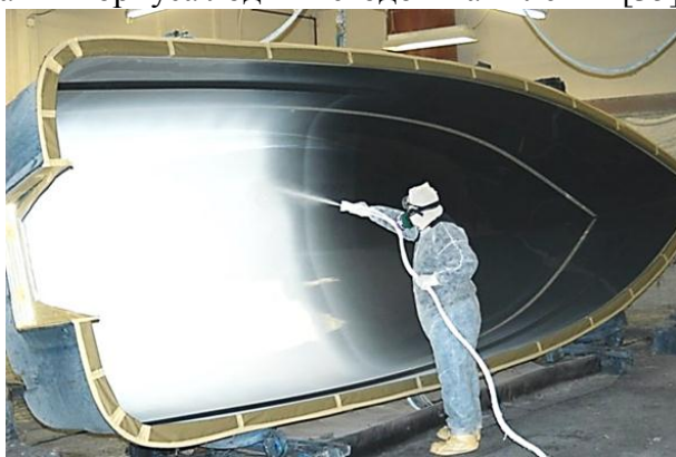
Рис. 12. Формование корпуса лодки методом напыления [35]
