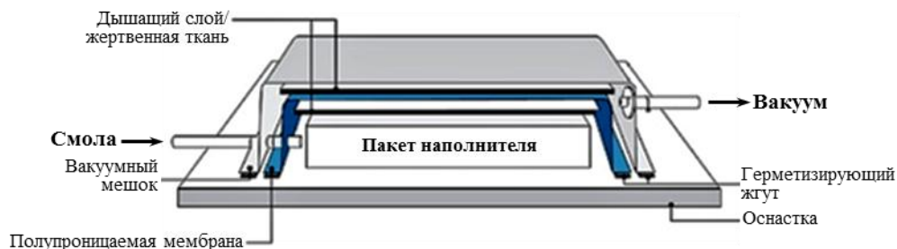
Рис. 7. Схема изготовления детали методом вакуумной инфузии с использованием полупроницаемой мембраны [23]
