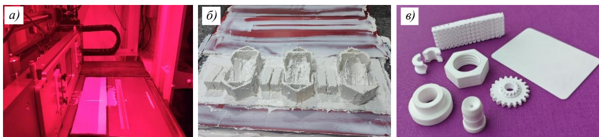
Рис. 6. Процессы SLA-печати полимерно-керамических изделий (а), удаления неотвержденной фотоотверждаемой керамической пасты (б), примеры изделий из алюмооксидной керамики, полученных по технологии SLA (в)
