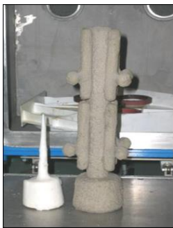
Рис. 2. Вид удаленного модельного состава и оболочковой формы
