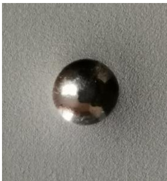
Рис. 11. Внешний вид отпечатка бойка на никелированном образце после испытания на прочность покрытий при ударе
