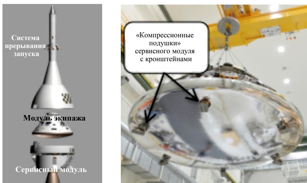
Рис. 2. Компоненты многоцелевого пилотируемого корабля «Орион» (NASA): модуль экипажа, сервисный модуль (а) и модуль экипажа космического корабля «Орион» (конструкция 2014 г.) с конструкционными элементами («компрессионными подушками»), подготовленный для присоединению к сервисному модулю (б) [50]
