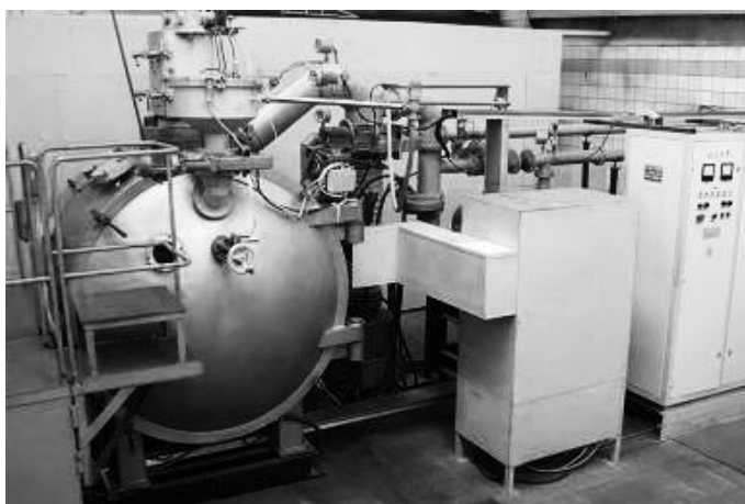
Рисунок 1. Общий вид вакуумной индукционной печи ВИАМ-2002
